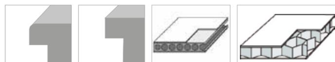
Zaobljeni rub Oštri rub Cjevasta iverica Kartonsko saće
