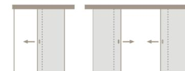
Klizna vrata BASIC, izvedba "Klizanje pored zida", jedno-krilna ili dvokrilna
